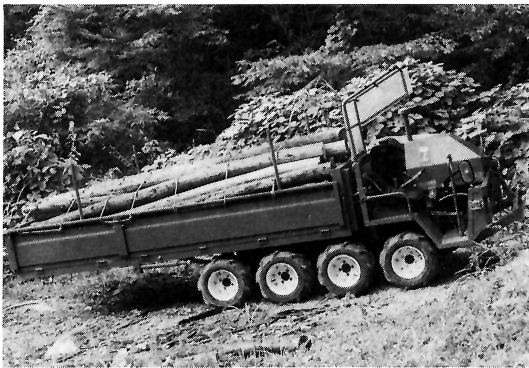
附 図 一 5 間伐材を積載した供試 8 輪型車 (作製した主荷台と延長荷台を車台に装着している)
