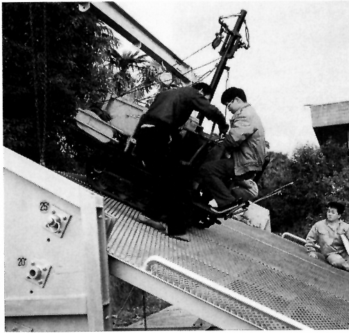
附図一 9 実験斜面 (25°こう配) 上の供試クローラ型車 (登坂試験)
